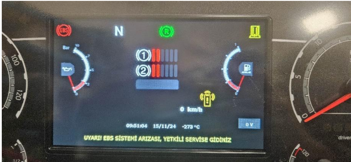
Görsel 9. Gösterge Paneli Üzerinde Arıza Uyarı İşareti
